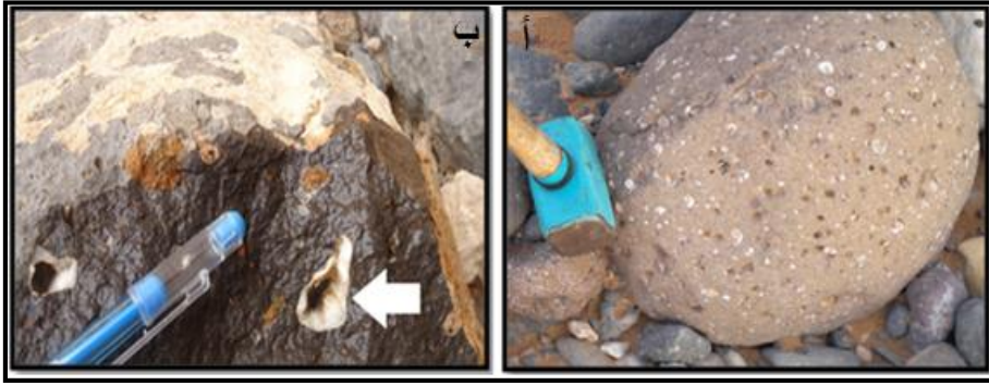
شكل(10): النسيج اللوزي Amygdaloidal texture
